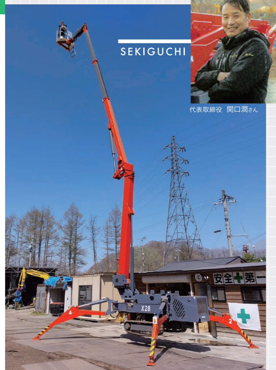
狭い場所でも進入できる高所作業車「KX-28」。スパイダー脚で不整地でも安全性は抜群！
